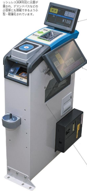
乗客・運転士の双方が確認できる液晶表示。カード・現金の区別、大人・小人の人数(割引運賃適用の人数)、カードの場合は引去額・投入額・残額、現金の場合は運賃・投入額が表示されます。
