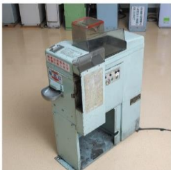
両替の硬貨を両替に利用する運賃箱ですが、紙幣は外づけの高替機に1枚ずつ投入する機種です。
