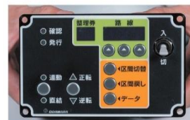
最新機種の整理券発行機と運転席に設置される操作盤。整理券機はインクのいらぬ感熱式です。
