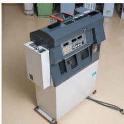
磁気式カードに対応し、投入額が表示されるタイプです。複数投入の運賃をカードから一括して収受できるよう、運転士の操作盤が装着されました。
