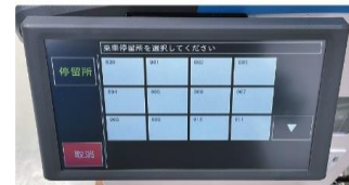
運転士用の液晶タッチパネル。人数、各種割引を設定してカードから運賃を収受できます。また乗車時にカードをタッチしなかった乗客には、別画面から乗車停留所を選んで運賃を収受できます。
