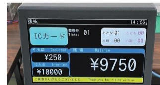
乗客・運転士の双方が確認できる液晶表示。カード・現金の区別、大人・小人の人数(割引運賃適用の人数)、カードの場合は引去額・投入額・残額、現金の場合は運賃・投入額が表示されます。
