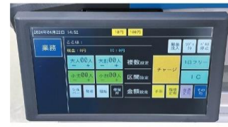
乗客・運転士の双方が確認できる液晶表示。カード・現金の区別、大人・小人の人数(割引運賃適用の人数)、カードの場合は引去額・投入額・残額、現金の場合は運賃・投入額が表示されます。
