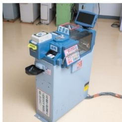
ICカードに対応し、投入額が液晶表示に、運転士の操作盤がソフトタッチに変更されました。
